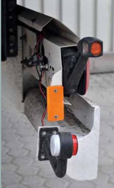
*Der Prototyp eines optischen Rückfahrwarners ist derzeit in der Erprobung.*
