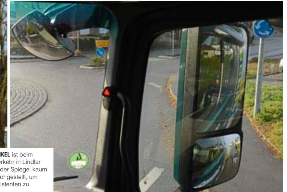
**EIN RADFAHRER IM TOTEN WINKEL** ist beim Abbiegen wie hier im Kreisverkehr in Lindlar selbst bei bester Einstellung der Spiegel kaum zu sehen. Diese Szene ist nachgestellt, um die Wirkung des Abbiegeassistenten zu demonstrieren.
